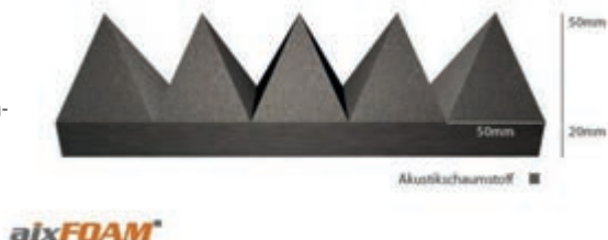
Abb. 4: Schaumstoffpyramidenmatten, Höhe 5 - 10 Zentimeter; gute Absorption im Mitten- und Höhenbereich
